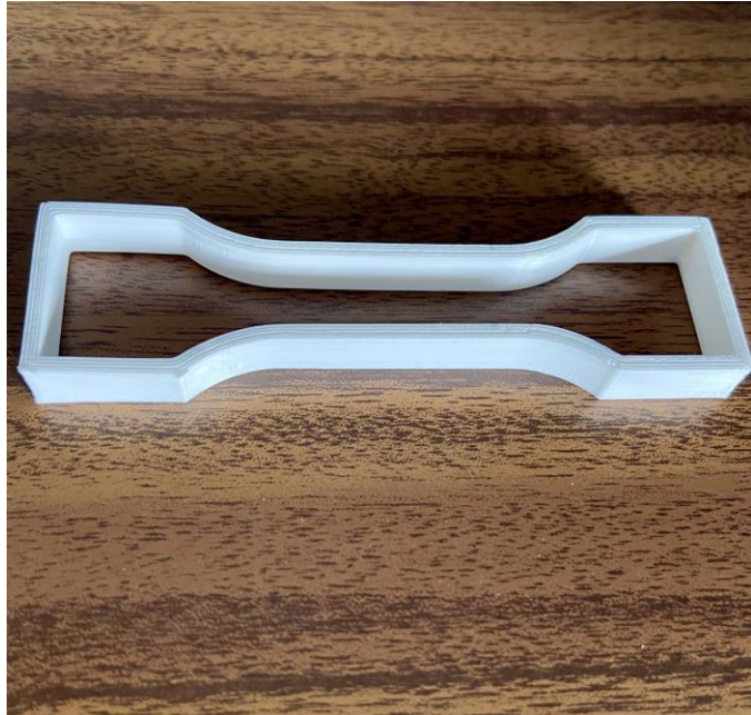
Stampo dove viene colato l'idrogel per realizzare i campioni
